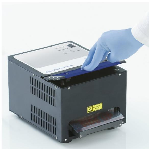
9. Quando o mecanismo de selagem estiver abaixado, uma luz laranja Sealing "Selagem" acende. Se o Rotor-Disc Loading Block não estiver na posição correta, um sinal sonoro de aviso soará.
