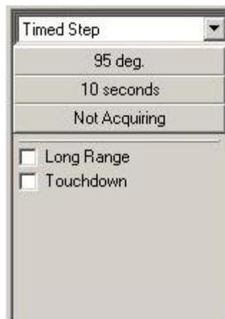
Após clicar no botão Not Acquiring (Não adquirir dados), a janela Acquisition (Aquisição) é exibida.
