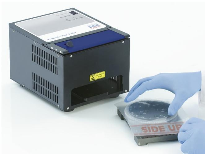
7. Deslize o conjunto no Rotor-Disc Heat Sealer usando os trilhos-guia na lateral do Rotor-Disc Loading Block. Certifique-se de que o Rotor-Disc Loading Block foi completamente inserido.
