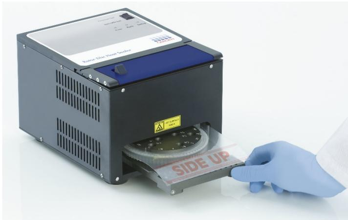
8. Para ativar o mecanismo de selagem, primeiro pressione para baixo a barra azul anodizada no topo do Heat Sealer e, em seguida, empurre a trava preta de volta.
