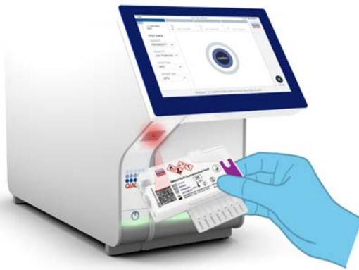
**Figura 13. Scansione del codice a barre della QIAstat-Dx Gastrointestinal Panel Cartridge.**
