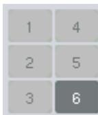
3. Placez le portoir de normalisation vide dans l'adaptateur approprié, puis dans la fente 6 ou, si le logiciel le demande, dans la fente 4 pour une normalisation en deux étapes ou lorsque le nombre de positions de réactions est supérieur au nombre de positions disponibles dans un portoir de normalisation.
