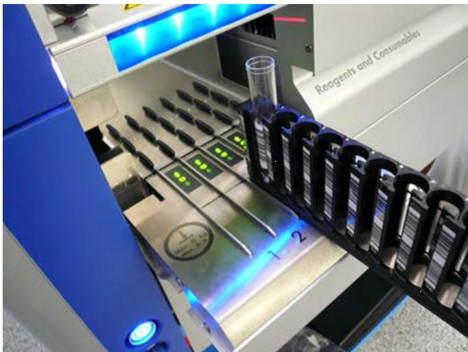
Insertion d'un porte-tubes dans la fente appropriée.
