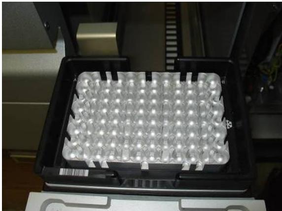
Adaptateur placé sur le châssis de transfert dans la fente 1 du tiroir « Eluate » (Éluats).
