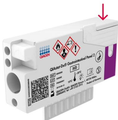
**Figura 16. Colocación del código de barras del identificador de muestra.**
