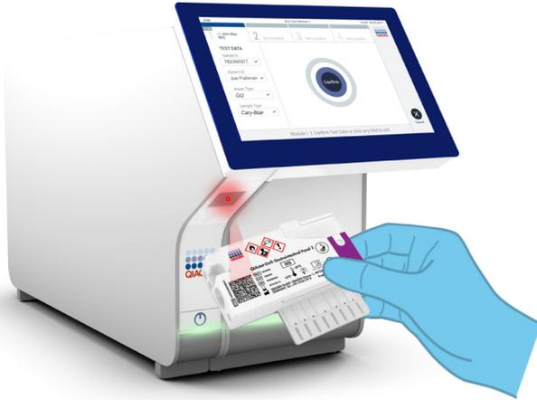
**Figura 11. Escaneo del código de barras del QIAstat-Dx Gastrointestinal Panel 2 Cartridge.**
