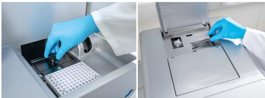
Figura 3. Extracción del seguro para el transporte.
