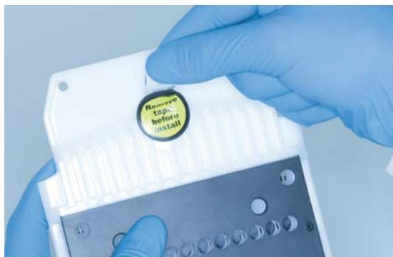
**Figura 6. Preparación del QIAxcel Gel Cartridge.**
