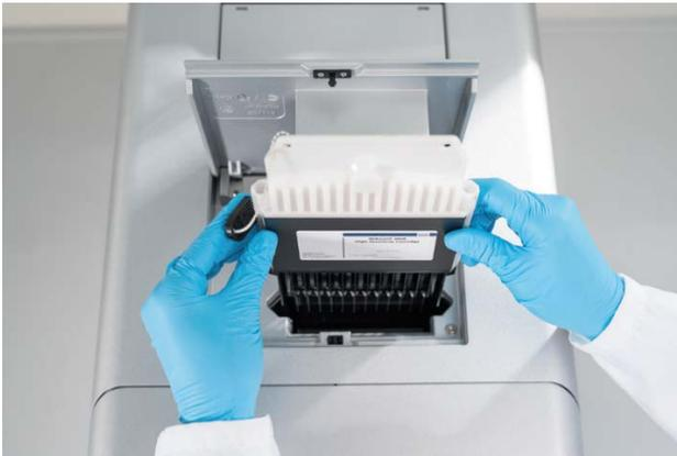
Figura 9. Instalación del QIAxcel Gel Cartridge.
