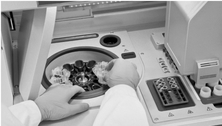
Abbildung 21: Beladen der Zentrifuge beim QIAcube Connect MDx Setzen Sie die bestückten Rotoradapter in die Zentrifugenbecher.
