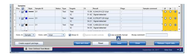
Le colonne del referto "Test Results - Overview" (risultati analisi - panoramica) mostrano lo stato di approvazione di ogni campione e controllo (A), il risultato in unità di concentrazione e notazione scientifica (B) e gli eventuali flag assegnati a un target (C)
