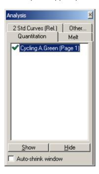
Si aprono tre finestre: la schermata principale, la curva standard e i risultati. Adattare le opzioni di analisi come richiesto (ad es. impostare una soglia, attivare la normalizzazione con provetta dinamica, applicare la correzione della pendenza, ecc.).
