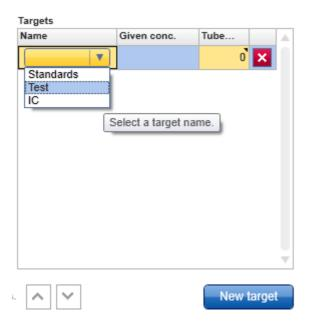
34. Selezionare un target specifico dall'elenco a discesa e inserire la posizione della provetta, tra quelle di quel tipo di campione o di controllo, in cui sarà analizzato il target. Il valore inserito deve essere compreso tra 1 e il numero di provette specificato per quel tipo di campione o di controllo.
