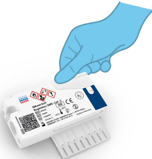
**Figura 22. Cierre de la tapa de la muestra del puerto principal.**
