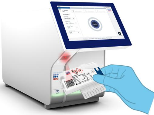
Figura 25. Escaneo del código de barras del QIAstat-Dx Respiratory SARS-CoV-2 Panel Cartridge.
