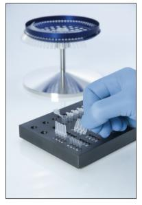
3. Insira os tubos de tira no 72-Well Rotor, certificando-se de que todos os tubos estejam devidamente encaixados e na orientação correta.
