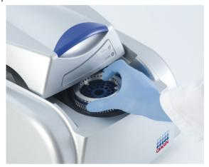
6. Feche a tampa e configure o perfil de execução usando o software Rotor-Gene Q.
