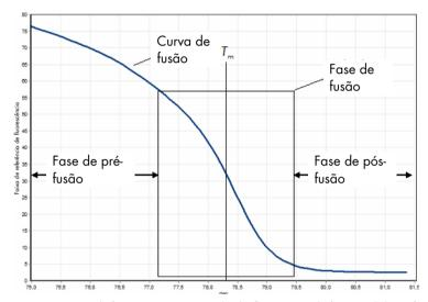
Um gráfico de HRM típico. A curva de fusão traça a transição da alta fluorescência da fase inicial de pré-fusão, por meio da diminuição da fluorescência da fase de fusão, até o nível basal de fluorescência na fase de pós-fusão. A fluorescência diminui conforme o corante intercalante de DNA é liberado do dsDNA, dissociando-se em cadeias simples. O ponto médio da fase de fusão, quando a taxa de alteração da fluorescência é maior, define a temperatura de dissociação (Tm) do DNA sendo analisado.
