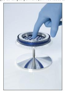
Insira o conjunto na câmara do Rotor-Gene Q MDx até encaixar no devido lugar usando o pino de posicionamento no encaixe do rotor. Para removê-lo, basta pressionar o encaixe do rotor para baixo para liberar e retirar.
