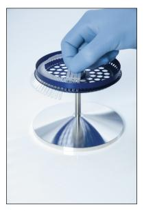
Importante: Para atingir uma uniformidade de temperatura máxima, todas as posições do rotor devem conter um tubo. Preencher todas as posições do rotor garante um fluxo de ar homogêneo para cada tubo. Mantenha um conjunto de tubos vazios tampados que podem ser usados para preencher posições não usadas.
