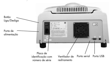
Nota: Conecte o Rotor-Gene Q MDx ao computador somente com os cabos serial e USB fornecidos com o instrumento. Não use outros cabos.
