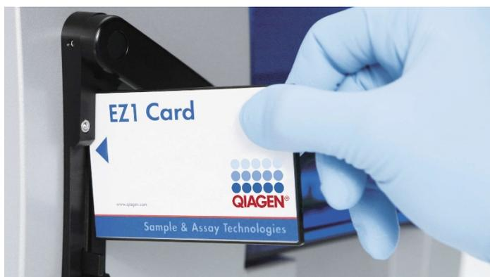
**Figura 6. Preparazione agevolata del protocollo tramite le card EZ1 DSP.** Inserimento di una EZ1 Card, preprogrammata con il protocollo, nello strumento EZ1.
