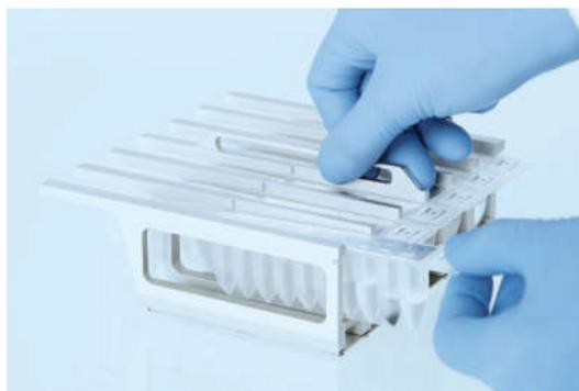
**Figura 9. Caricamento del rack per cartucce reagenti.** Il rack delle cartucce stesso è contrassegnato da una freccia che indica la direzione nella quale devono essere caricate le cartucce reagenti (RCV).
