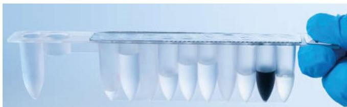
**Figura 2. Cartuccia reagenti (RCV).** Cartuccia reagenti (RCV) sigillata e preriempita dell'EZ1 DSP Virus Kit.
