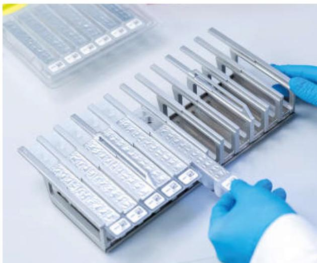
**Figura 3. Rack cartucce reagenti.** Il rack delle cartucce stesso è contrassegnato da una freccia che indica la direzione nella quale devono essere caricate le cartucce reagenti (RCV).
