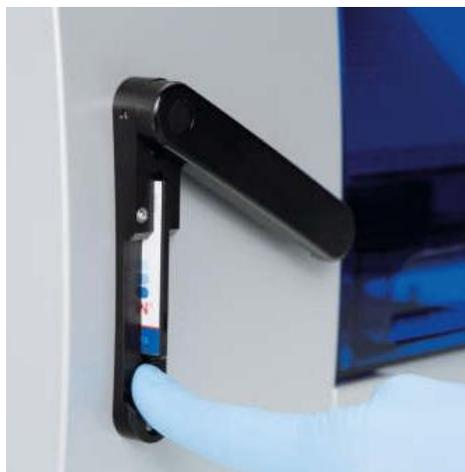
Figura 7. Card completamente inserita nella slot per EZ1 Card.
