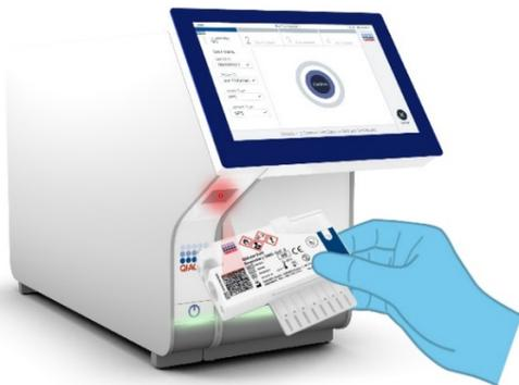
**Figure 45. Lecture du code-barres de la QIAstat-Dx Respiratory SARS-CoV-2 Panel Cartridge.**
