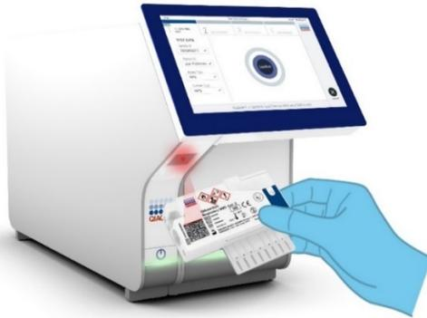
Figure 12. Lecture du code-barres de la QIAstat-Dx Respiratory SARS-CoV-2 Panel Cartridge.
