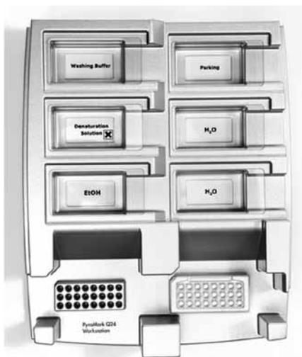
図 2. ワークステーションに PCR プレート (またはストリップ) および PyroMark Q24 Plate をセット
