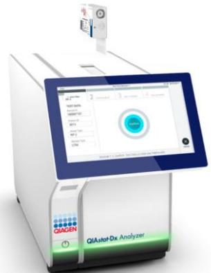
6. Une fois le test terminé, l'écran Eject (Éjection) apparaît et l'un des résultats de test suivants s'affiche : TEST COMPLETED (Test terminé), TEST FAILED (Test échoué) ou TEST CANCELED (Test annulé).
