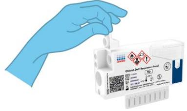
4. Insérez l'écouvillon dans la QIAstat-Dx Respiratory Panel Cartridge jusqu'à ce que la zone de cassure soit dans l'alignement de l'ouverture d'accès (l'écouvillon ne peut pas aller plus loin).
