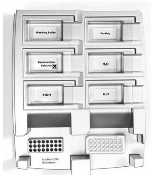
**Figura 3.** Colocação da placa de PCR (ou tiras) e da placa PyroMark Q24 na estação de trabalho de vácuo.
