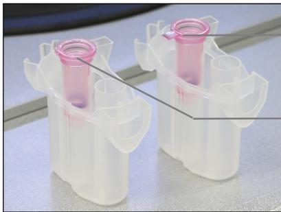
Bouchon de la colonne mal retiré, une partie du bouchon est toujours présente
