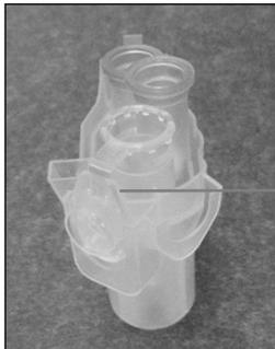
Bouchon du tube de microcentrifugation de 1,5 ml pas assez enfoncé dans le logement
