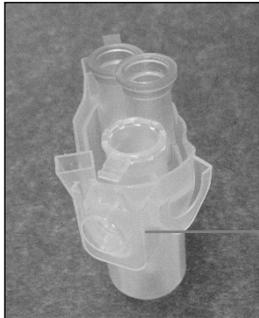
Bouchon du tube de microcentrifugation de 1,5 ml dans la bonne position
