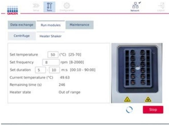
Écran de fonctionnement de Heater Shaker (appareil de chauffage/agitateur).
