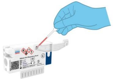
5. Chiudere saldamente lo sportellino del campione della porta principale finché non scatta. Verificare visivamente che il campione sia caricato utilizzando la finestra di ispezione del campione della QIAstat-Dx Respiratory Panel Cartridge.
