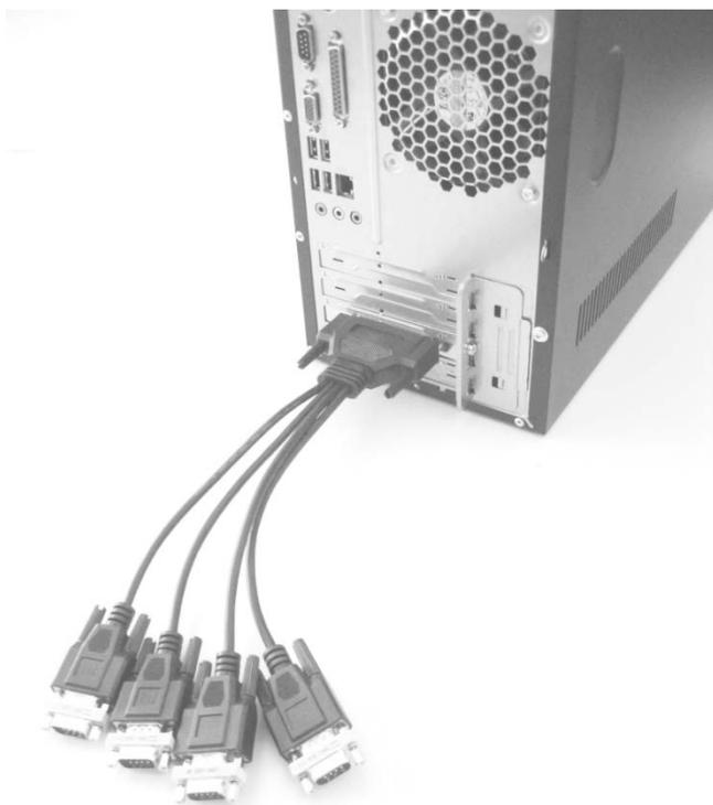
2. Ligue os cabos de série RS-232 aos conectores pequenos do cabo múltiplo de 4 fichas. Utilize os parafusos para fixar a ligação.
