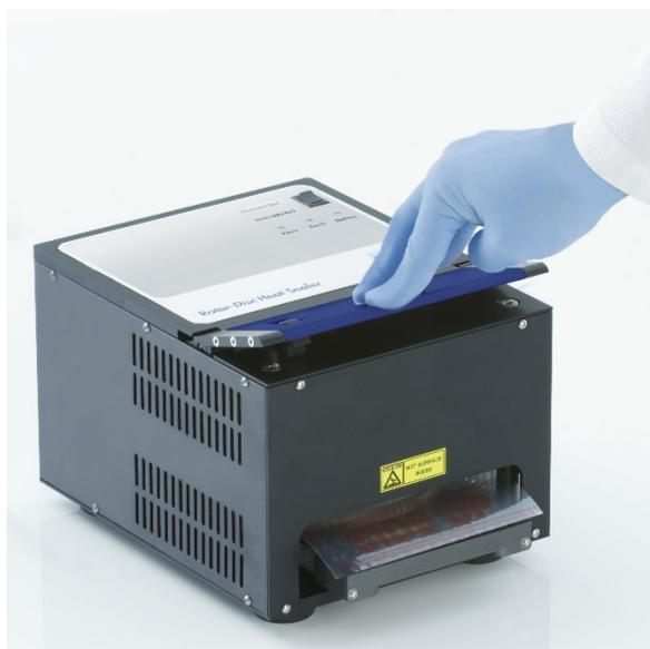
9. Quando o mecanismo de selagem tiver baixado, acende-se uma luz laranja "Sealing" (A selar). Caso o Rotor-Disc Loading Block não esteja na posição correta, é emitido um sinal sonoro de aviso.
