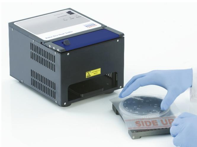
7. Deslize o conjunto para dentro do Rotor-Disc Heat Sealer utilizando as calhas guia nas laterais do Rotor-Disc Loading Block. Certifique-se de que o Rotor-Disc Loading Block está totalmente inserido.
