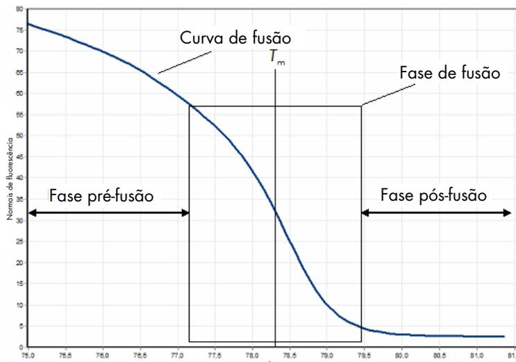
Um gráfico de HRM comum. A curva de fusão traça a transição desde a fluorescência elevada da fase de pré-fusão inicial, passando pela diminuição na fluorescência da fase de fusão, até ao nível de fluorescência basal da fase de pós-fusão. A fluorescência diminui à medida que o corante intercalado de ADN é libertado do dsDNA e se funde em cadeias simples. O ponto médio da fase de fusão, no qual a taxa de variação da fluorescência é maior, define a temperatura de fusão ( $T_m$ ) do ADN em análise.
