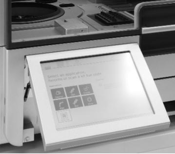
图 16: QIAcube Connect MDx 的拉出式触摸屏。
