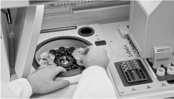
图 21: 加载 QIAcube Connect MDx 上的离心机。将组装好的转子适配器加载至离心机桶中。
