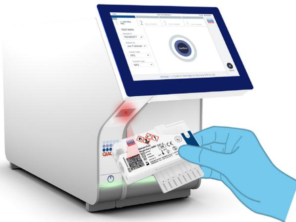
**Abbildung 12. Scannen des Barcodes der QIAstat-Dx Respiratory SARS-CoV-2 Panel Cartridge.**
