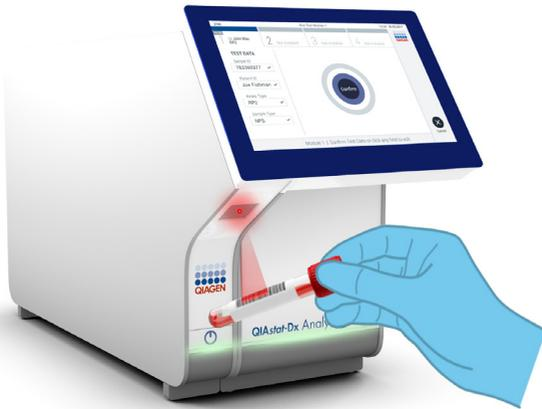
**Abbildung 24. Scannen des Proben-ID-Barcodes.**
