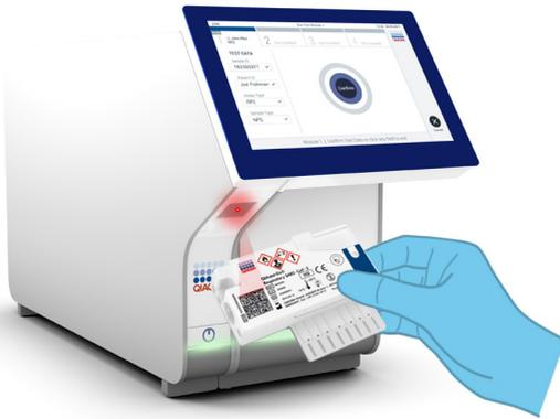
Abbildung 25. Scannen des Barcodes der QIAstat-Dx Respiratory SARS-CoV-2 Panel Cartridge.
