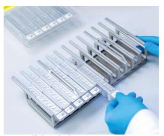
Figura 3. Gradilla de cartuchos de reactivos. La propia gradilla de cartuchos está etiquetada con una flecha que indica la dirección en la que hay que cargar los cartuchos de reactivos (RCV).
