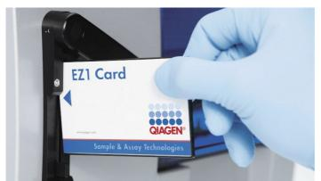
Figura 6. Facilidad para configurar un protocolo con las tarjetas EZ1 DSP Cards. Se inserta una tarjeta EZ1 Card, preprogramada con el protocolo, en el instrumento EZ1.
