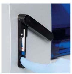
Figura 7. Tarjeta bien insertada por completo en la ranura para EZ1 Card.
