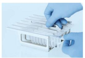
Figura 9. Carga de la gradilla de cartuchos de reactivos. La propia gradilla de cartuchos está etiquetada con una flecha que indica la dirección en la que hay que cargar los cartuchos de reactivos (RCV).
