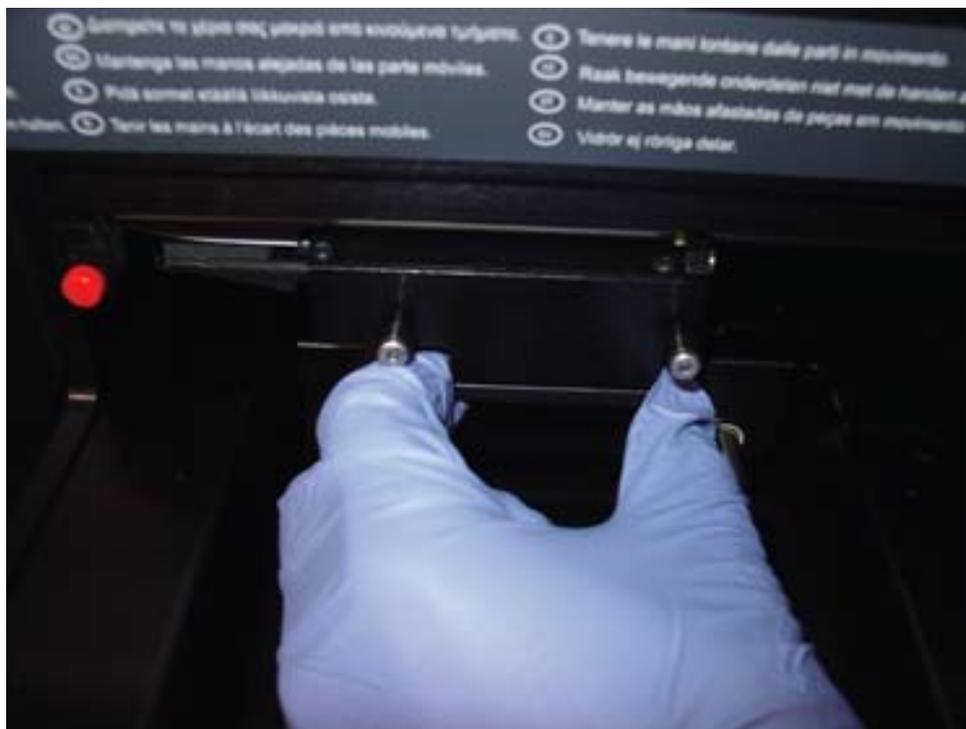
8. Nettoyer le masque optique et le dispositif de fixation du masque optique avec une serviette en papier peu pelucheuse humidifiée avec de l'alcool isopropylique à 70 %.
