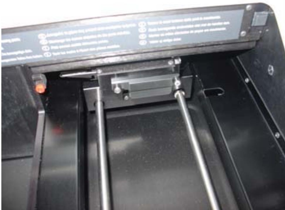
6. Soulever le côté gauche du dispositif de fixation du masque optique pour le détacher de la broche de gauche, puis tirer le dispositif de fixation du masque optique vers la gauche pour le détacher de la broche de droite.
