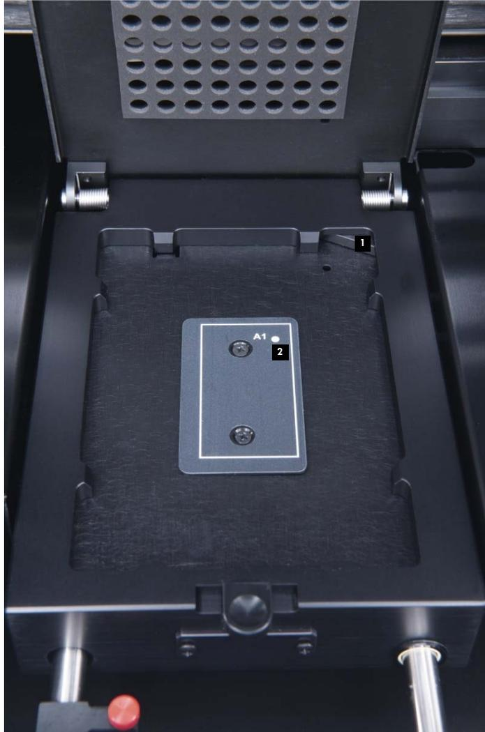
**1** Dispositif de positionnement de microplaque
