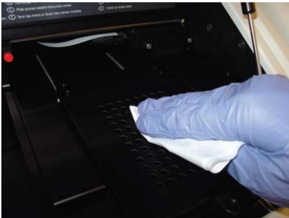
Exemple de nettoyage de l'intérieur du masque de plaque :
