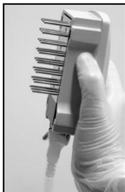
Figura 4. Illustrazione dello strumento di vuoto sollevato oltre i 90° in verticale.
