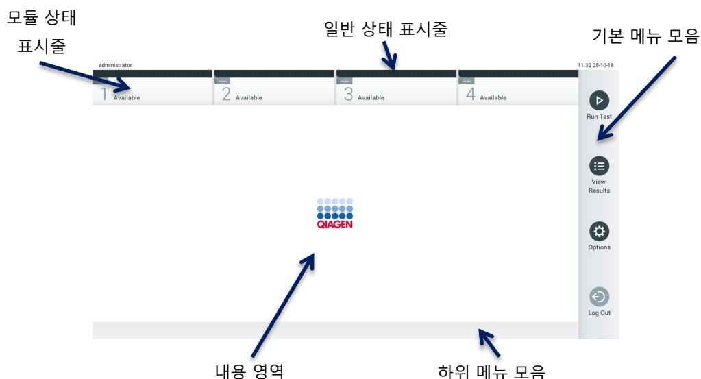
그림 41. QIAstat-Dx Analyzer 1.0 터치스크린의 기본 화면.
