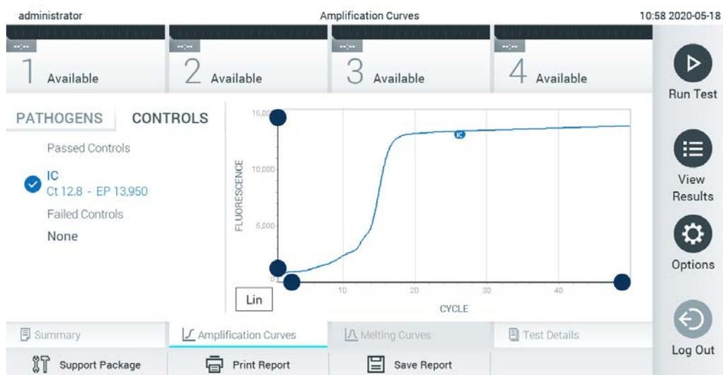
Figure 35. Écran des courbes d'amplification (onglet CONTROLS [TÉMOINS]) montrant les témoins internes.
