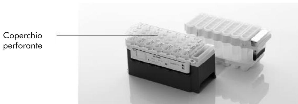
**Figura 3. Semplice preparazione della stazione di lavoro con cartucce reagenti (RC).**
