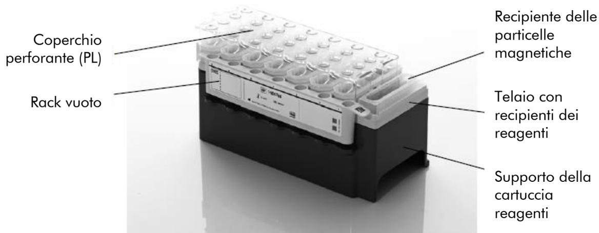
**Figura 2. Cartuccia reagenti QIASymphony (RC).** La cartuccia reagenti (RC) contiene tutti i reagenti necessari per l'esecuzione del protocollo.
