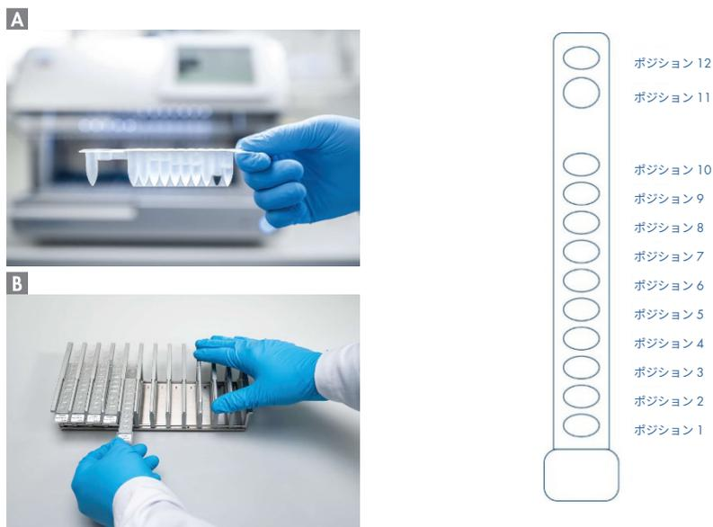
**図 1. 試薬カートリッジを使用した簡便なワークテーブルのセットアップ。** (A) 密封した充填済み試薬カートリッジ。充填レベルは、試薬カートリッジのタイプによって異なります。(B) 試薬カートリッジをカートリッジラックにセットします。カートリッジラック自体には、試薬カートリッジをセットする方向を示した矢印のラベルが付いています。
