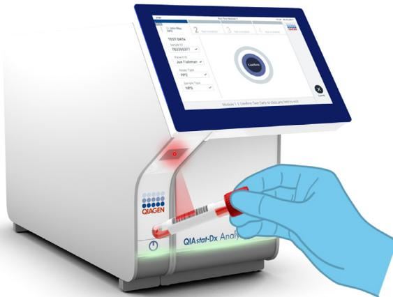
**Figure 11. Lecture du code-barres de l'identifiant d'échantillon.**
