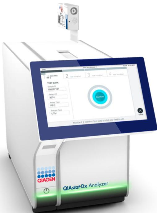
Figure 15. Insertion de la QIAstat-Dx Respiratory SARS-CoV-2 Panel Cartridge dans le QIAstat-Dx Analyzer 1.0.
