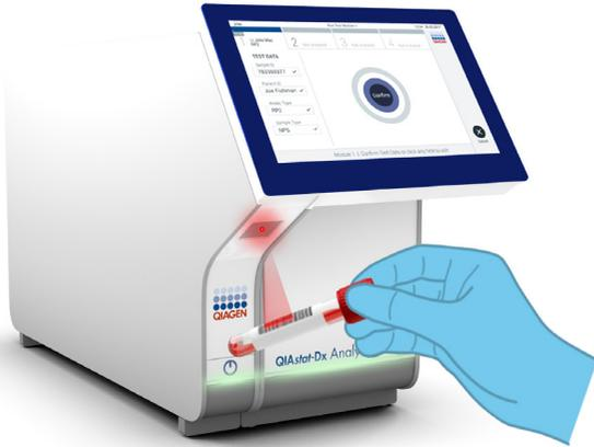
**Figure 24. Lecture du code-barres de l'identifiant d'échantillon.**
