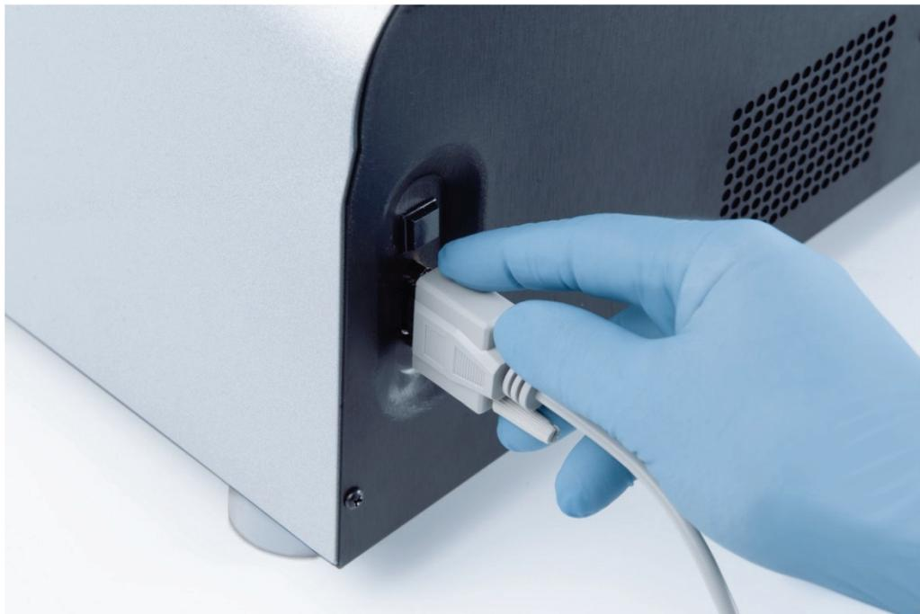
5. Sambungkan ujung lain dari kabel RS-232 ke port serial HC2 System PC, dan kencangkan sekrup pengunci.
