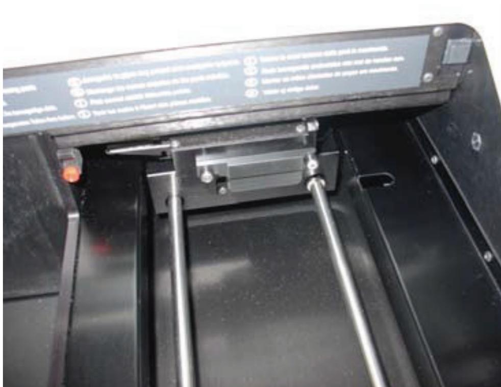
6. Dorong ke atas di sisi kiri penahan penutup optik untuk melepaskannya dari pin kiri, lalu tarik penahan penutup optik ke kiri untuk melepaskannya dari pin kanan.
