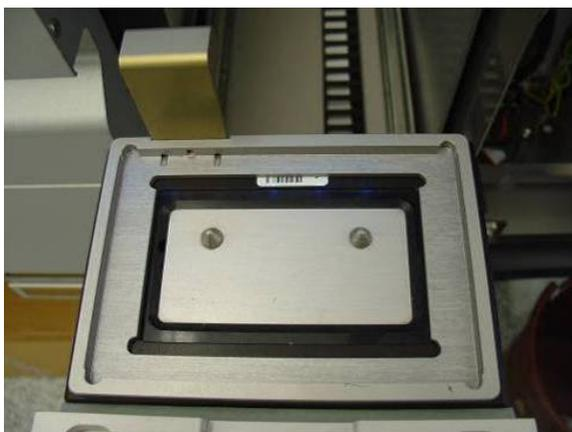
Estrutura de transferência colocada no slot 1 da gaveta "Eluate" (Eluição).
