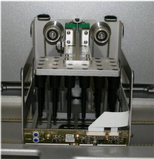
3. Limpe a parte externa do cabeçote magnético com um pano sem fiapos umedecido com desinfetante à base de etanol (por exemplo, Mikrozyd) e incube conforme apropriado.
