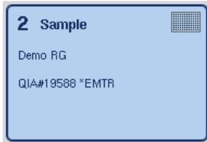
Le fichier de portoir sélectionné est attribué au slot « Sample » (Échantillon) sélectionné. Le type et l'ID de portoir définis dans le fichier de portoir sélectionné sont attribués au slot « Sample » (Échantillon) sélectionné. Le slot « Sample » (Échantillon) apparaît à présent en bleu et le bouton **Next** (Suivant) devient actif.
