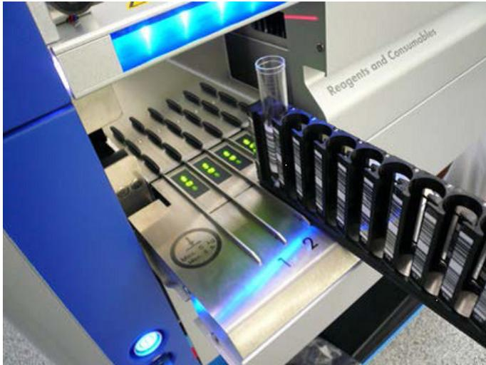
Insertion d'un porte-tube dans le slot adapté.
