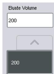
7. Pour remplacer le volume d'éluat par défaut, sélectionner le volume d'éluat voulu dans la liste **Eluate Volume** (Volume d'éluat) sur le côté gauche de l'écran.
