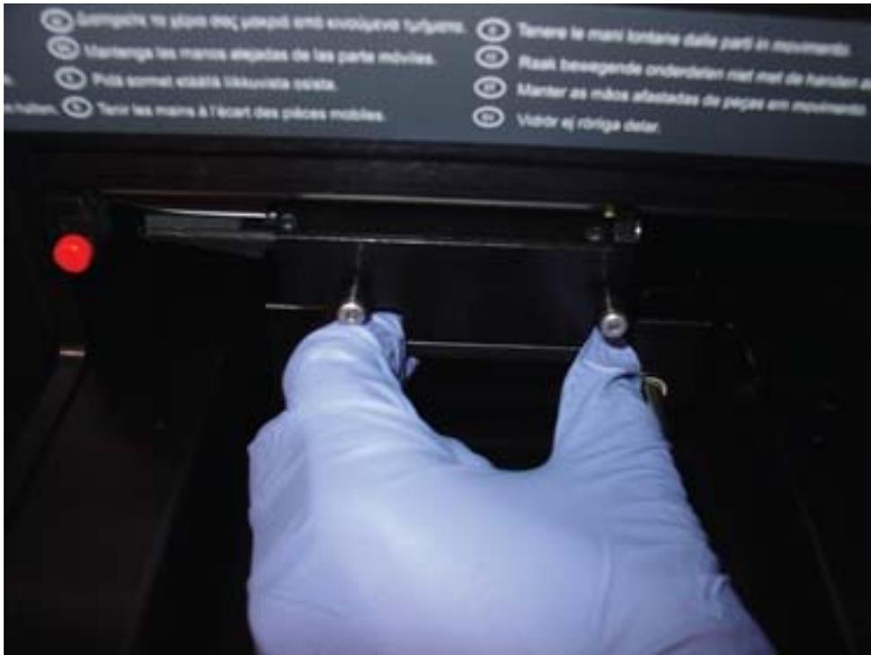
8. Pulire la maschera ottica e il relativo blocco con un panno di carta che non sfilaccia inumidito con alcol isopropilico al 70%.
