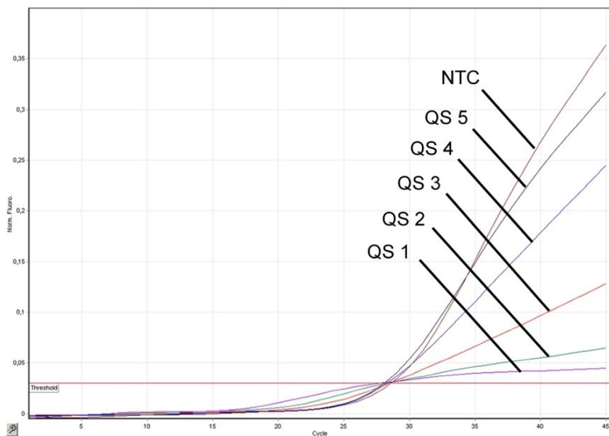
Rilevazione del controllo interno (IC) nel canale di fluorescenza Cycling Yellow con amplificazione contemporanea degli standard di quantificazione (HBV RG/TM QS 1-5). NTC: controllo no template (controllo negativo).
