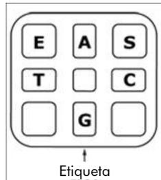
**Ilustración 5. Ilustración de la vista superior del cartucho PyroMark Q24.** Las anotaciones corresponden a la etiqueta de los viales de reactivos. Añada el volumen de mezcla de enzimas (**E**), mezcla de sustratos (**S**) y nucleótidos (**A**, **T**, **C**, **G**) que se indica en la información sobre volúmenes del informe de información previa de la serie, que encontrará en el menú "Tools" (Herramientas) durante la configuración del ensayo.
