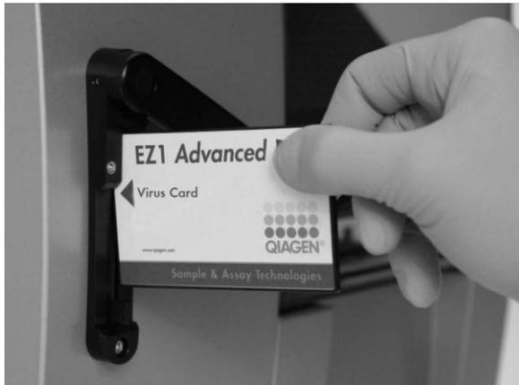
**Figure 1. Configuration facile des protocoles avec les cartes EZ1 DSP.** Insertion d'une carte EZ1, contenant le protocole préprogrammé, dans l'appareil EZ1.
