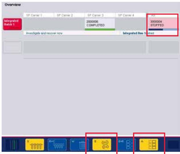
Lorsque le cycle est arrêté, tous les échantillons sont signalés comme « invalide ». Il n'est plus possible de poursuivre le traitement de ces échantillons.
