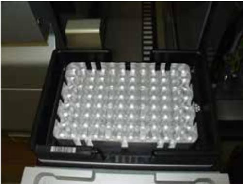
Adaptateur placé sur le châssis de transfert sur le slot 1 du tiroir « Éluat ».
