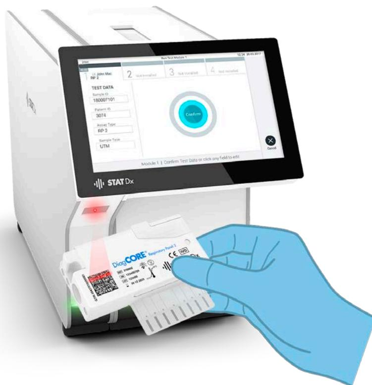
**NAPOMENA** Uređaj DiagCORE® Analyzer neće prihvatići kertridže kojima je istekao period važenja, one koji su prethodno korišćeni ili kertridže za analize koji nisu instalirani na uređaju. U tim slučajevima biće prikazane poruke sa greškom i kertridž će biti odbijen. Za više detalja pogledajte Korisnički priručnik za uređaj DiagCORE® Analyzer.
