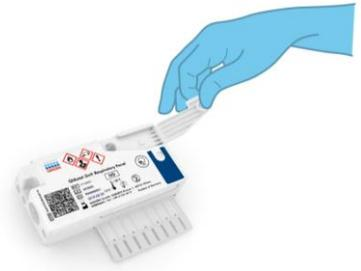
4. Öffnen Sie das Röhrchen mit der zu testenden Probe. Saugen Sie mit der mitgelieferten Transferpipette Flüssigkeit bis zur dritten Fülllinie der Pipette (d. h. 300 µl). **Überführen Sie die 300 µl Probenvolumen** vorsichtig in die Hauptöffnung.
