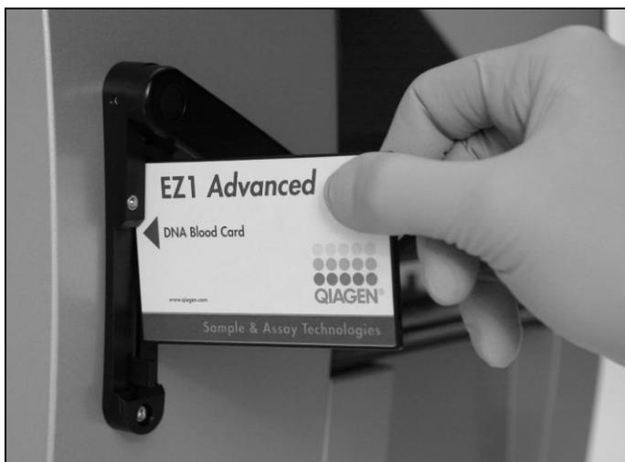
**Figura 9. Fácil instalación de protocolos utilizando tarjetas EZ1 DSP Cards.** Así se introduce en el EZ1 una tarjeta EZ1 Card, que contiene el protocolo.
