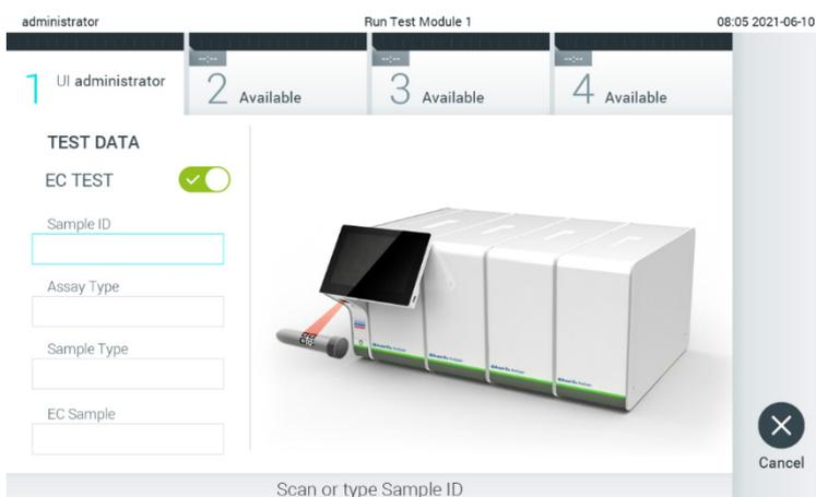
**Gambar 89.** Menyalakan tombol toggle EC Test untuk mengaktifkan pengujian EC.
