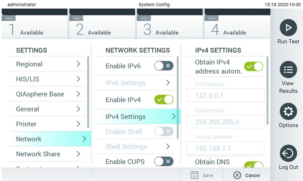
Figure 75. Configurer les paramètres du réseau.
