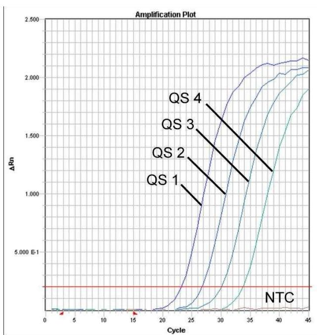
Fig. 27: Detecção dos Padrões de quantificação (EBV LC/RG/TM QS 1 - 4) através da detecção de um sinal de fluorescência FAM (**ABI PRISM 7900HT SDS**). NTC: non-template control (controlo negativo).
