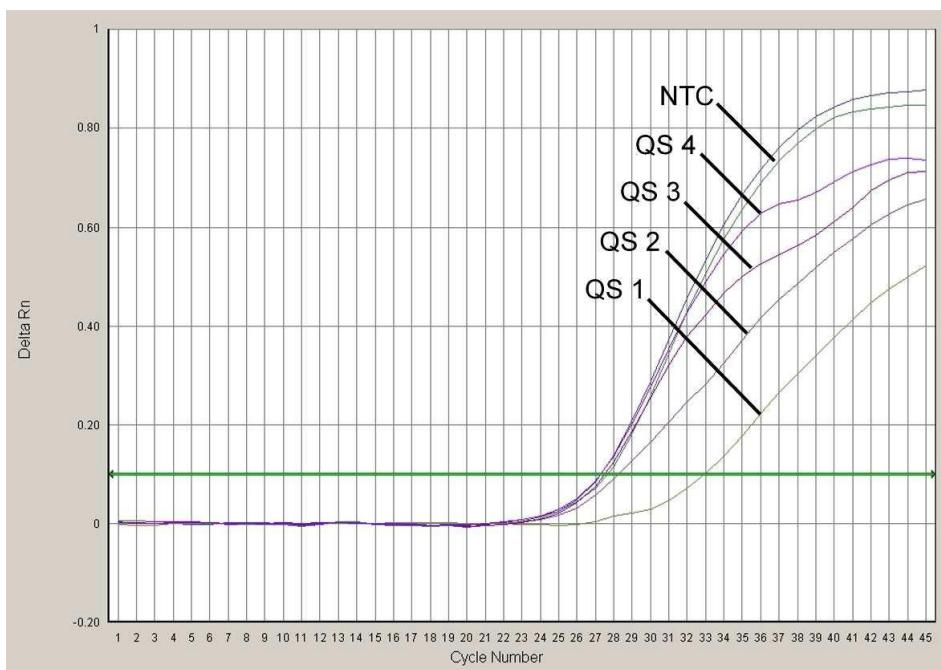
Fig. 24: Detecção do Controlo interno (IC) através da detecção de um sinal de fluorescência VIC (**ABI PRISM 7000 SDS**) no caso de amplificação simultânea dos Padrões de quantificação (EBV LC/RG/TM QS 1 - 4). NTC: non-template control (controlo negativo).
