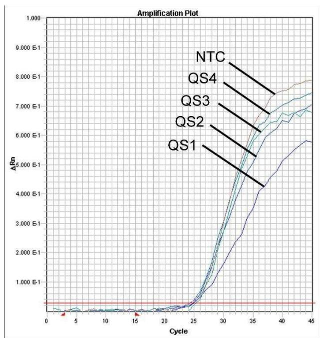
Fig. 28: Detecção do Controlo interno (IC) através da detecção de um sinal de fluorescência VIC (**ABI PRISM 7900HT SDS**) no caso de amplificação simultânea dos Padrões de quantificação (EBV LC/RG/TM QS 1 - 4). NTC: non-template control (controlo negativo).
