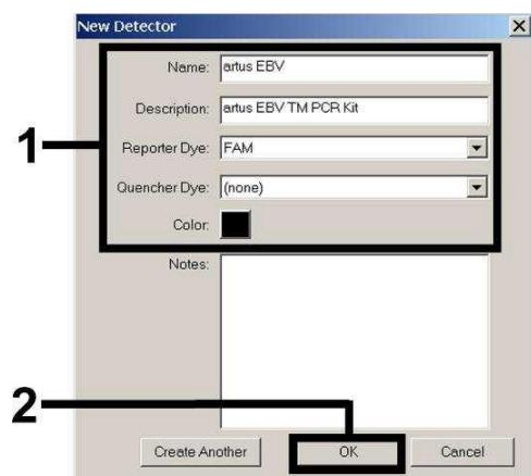
Fig. 4: Criação do detector específico do EBV (Detector Manager).
