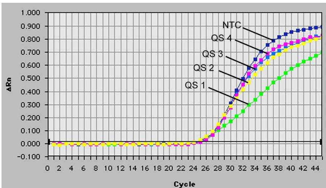
Fig. 26: Detecção do Controlo interno (IC) através da detecção de um sinal de fluorescência VIC (**ABI PRISM 7700 SDS**) no caso de amplificação simultânea dos Padrões de quantificação (EBV LC/RG/TM QS 1 - 4). NTC: non-template control (controlo negativo).
