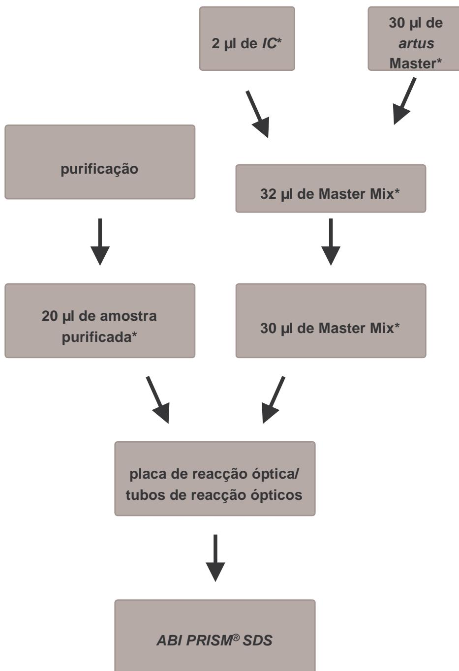
Fig. 2: Fluxo esquemático da operação para o controlo da inibição da PCR.
