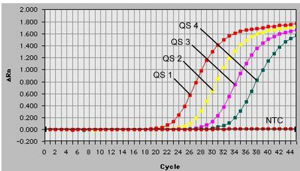
Fig. 25: Detecção dos Padrões de quantificação (EBV LC/RG/TM QS 1 - 4) através da detecção de um sinal de fluorescência FAM (**ABI PRISM® 7700 SDS**). NTC: non-template control (controlo negativo).
