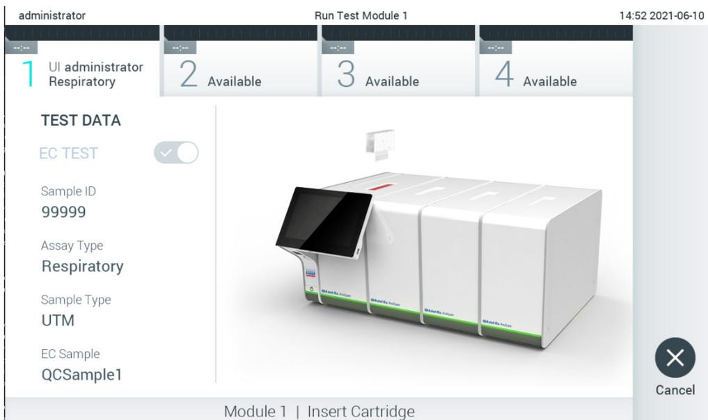
Figura 94. Introducción del cartucho de ensayo QIAstat-Dx en el QIAstat-Dx Analyzer 1.0.
