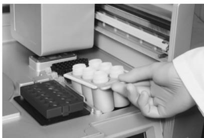
**Figura 17: Carregando o rack de frascos de reagente. [A]** Esquema das posições e do conteúdo dos frascos no rack de frascos de reagente. **[B]** Carregando o rack no QIAcube Connect MDx.
