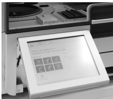
Figura 16: Tela sensível ao toque do QIAcube Connect MDx levantada.
