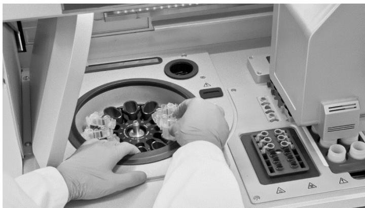
**Figura 21:** Carregando a centrífuga no QIAcube Connect MDx. Carregue os Rotor Adapters montados nos recipientes da centrífuga.
