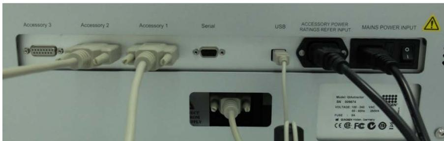
12. Collegare un'estremità del cavo di alimentazione CA (cavo di rete IEC standard a 3 fili) al connettore di alimentazione della stazione di controllo del vuoto. Collegare l'altra estremità alla presa di corrente CA.
