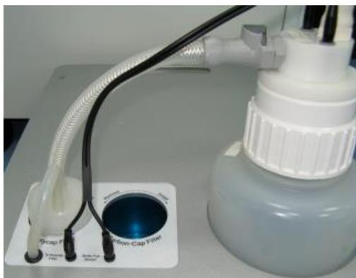
9. Avvitare il filtro Carbon-Cap nell'apertura corretta sulla stazione del vuoto. Accertarsi di posizionare il filtro con l'etichettatura capovolta.
