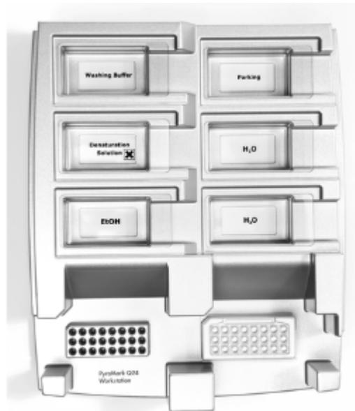
Figura 3. Posicionamento da placa (ou das tiras) de PCR e da placa PyroMark Q24 na estação de trabalho de vácuo.
