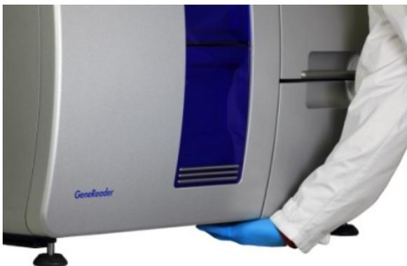
Figura 2. Imagen en la que se ilustra cómo abrir manualmente la tapa del instrumento GeneReader.
