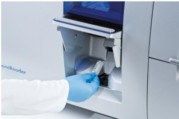
Figura 4. Carga de la celda de flujo de GeneReader.
