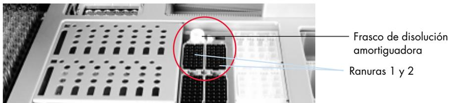
Ranura del frasco de disolución amortiguadora.
