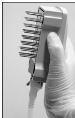
Figura 3. Illustrazione dello strumento del vuoto sollevato e inclinato di oltre 90° in senso verticale.
